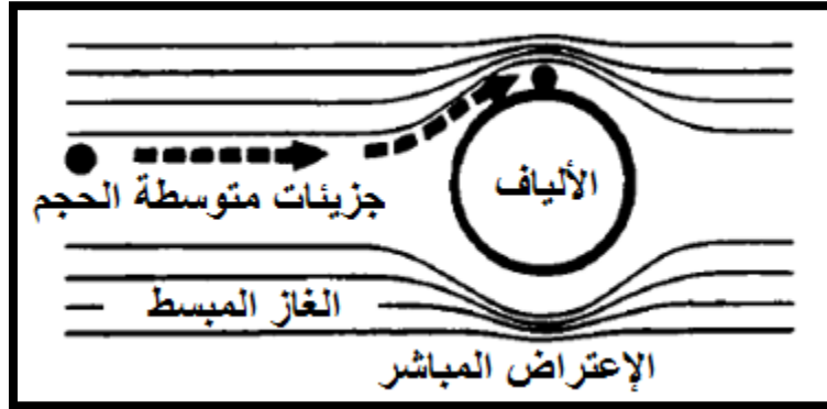
شكل (3.4) يوضح الإعتراض المباشر لجزيئات متوسطة الحجم
