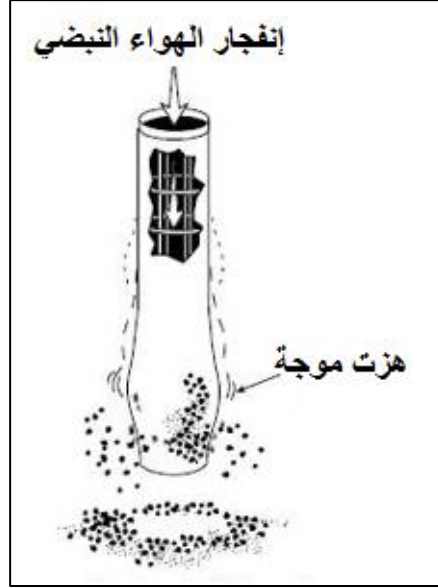
شكل (13.4) يوضح طريقة تجميع الغبار
